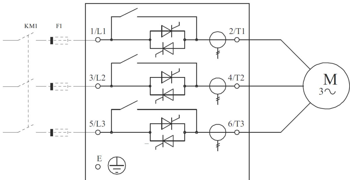
2) Подключение УПП в цепь питания треугольника, с использованием встроенного байпаса. KM1 – вводной контактор, F1 – предохранители. Параметры: A20 = 1, E11 = 1.
